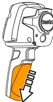
3 - Déverrouiller l'accumulateur et le retirer.
